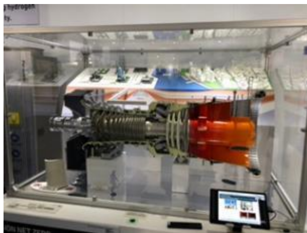
水素ガスタービン
